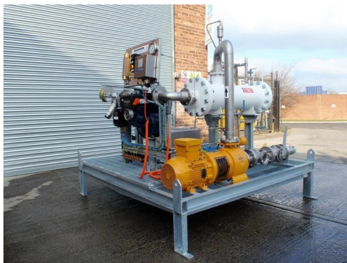
Рис. 2.6. Системи перекачування авіаційного палива [46].
