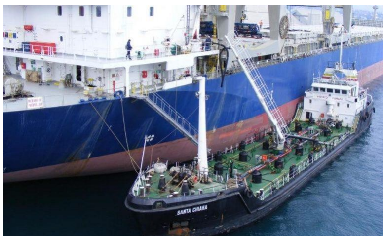
Рис. 2.17. Бункерування паливом з судна-бункерувальника [58].
