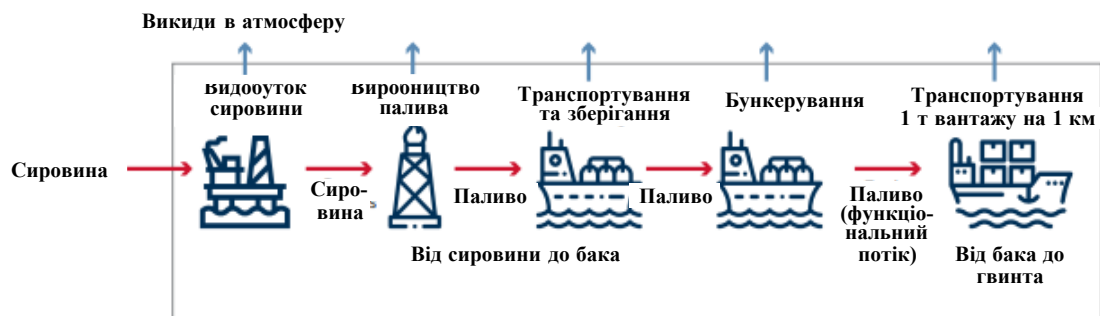
Рис. 2.10. Життєвий цикл палив для водного транспорту від «свердловини до гвинта» [53].
