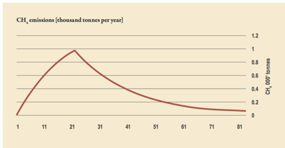
Figura 5 - Curba tipică de generare a CH 4 de la depozitul de deșeuri în timp 3
